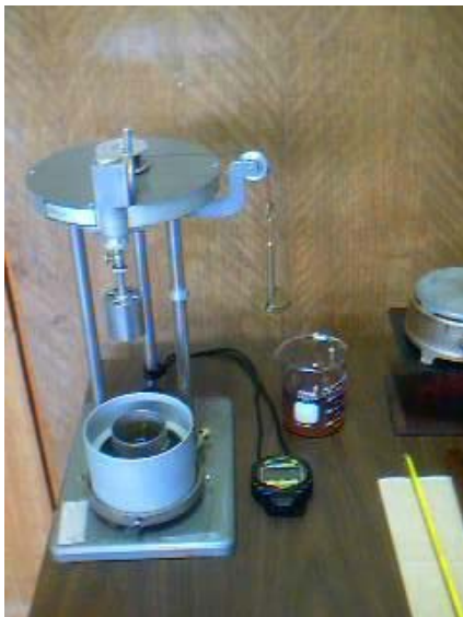
Figura 1: Viscosímetro Stormer , con los equipos y/o instrumentos a emplear en la práctica.
